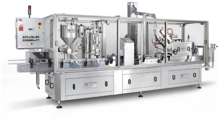
Abbildung 18 Monoblock Mod. DCC (Produkt füllen und mit Kappen verschliessen)
